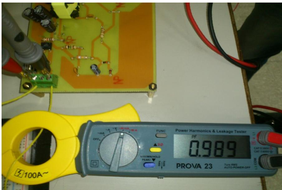
圖 4-14(b) 升壓型轉換器功率因數實際測量圖
